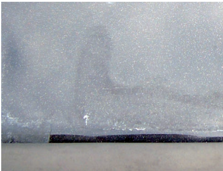
Bild 7-002 Fleckenbildung durch Gummunterlagen eines Dachgepäckträgers (Vergrößerung)
