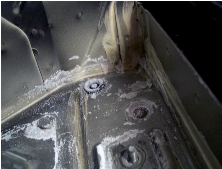
Bild 7-004 Batteriesäureschaden durch Überladung der Batterie
